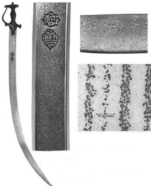
Una espada de Damasco de siglos de antigüedad, y detalles de su hoja. El grado de resolución de la imagen inferior derecha es micrométrico. (Imagen: © Science China Press)
