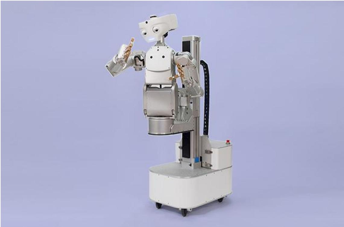
Se muestra aquí el M1 de Meka Robotics, un robot humanoide con dos brazos diseñado para levantar y transportar objetos. (Foto: Cortesía de Meka Robotics)
