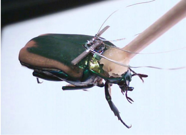
En la Universidad de Michigan se trabaja en aprovechar la energía biológica de insectos para energizar dispositivos electrónicos instalados en ellos. Foto: Erkan Aktakka / U. Michigan
