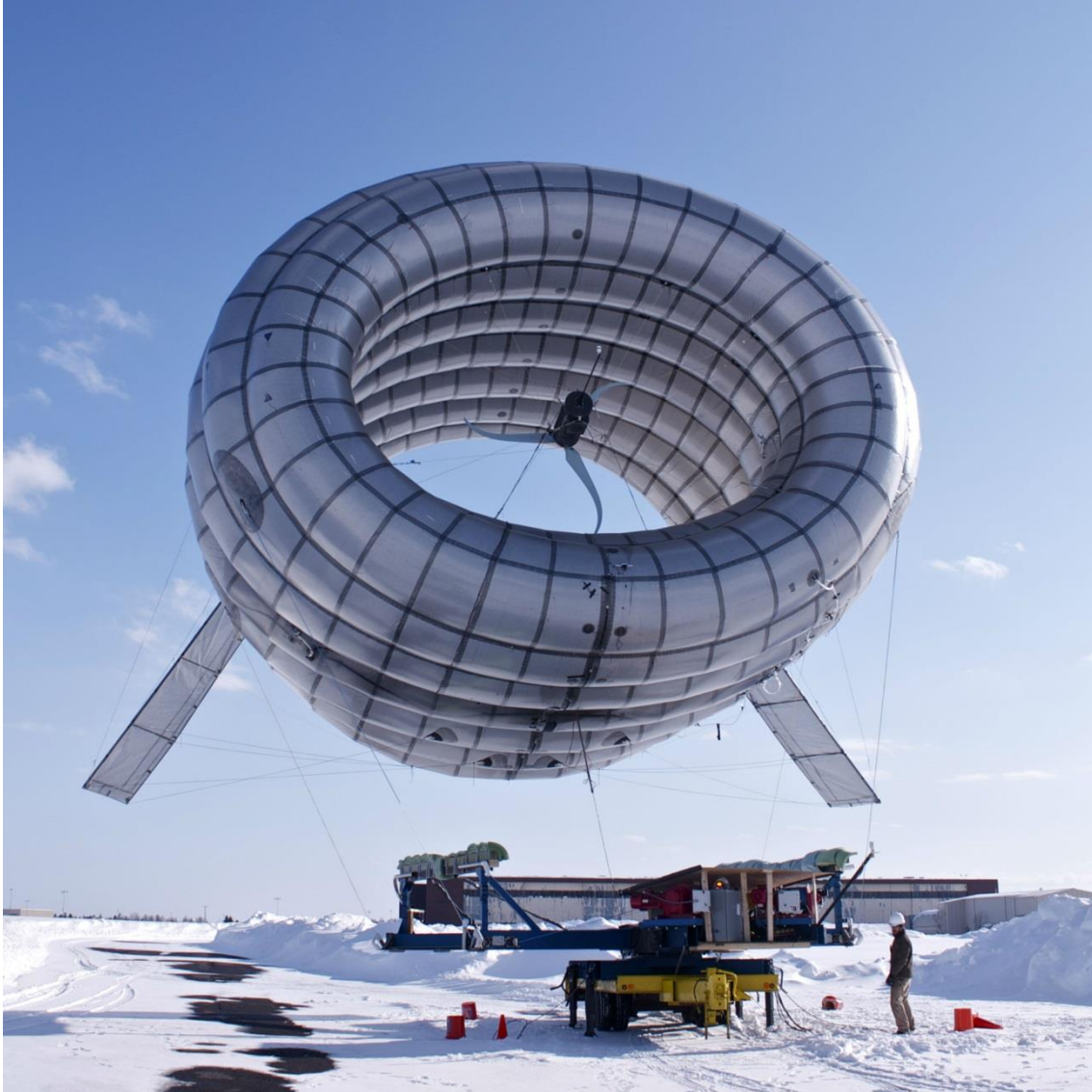
El aerogenerador aerostático BAT desarrollado por Altaeros Energies. (Imagen: Altaeros Energies)
