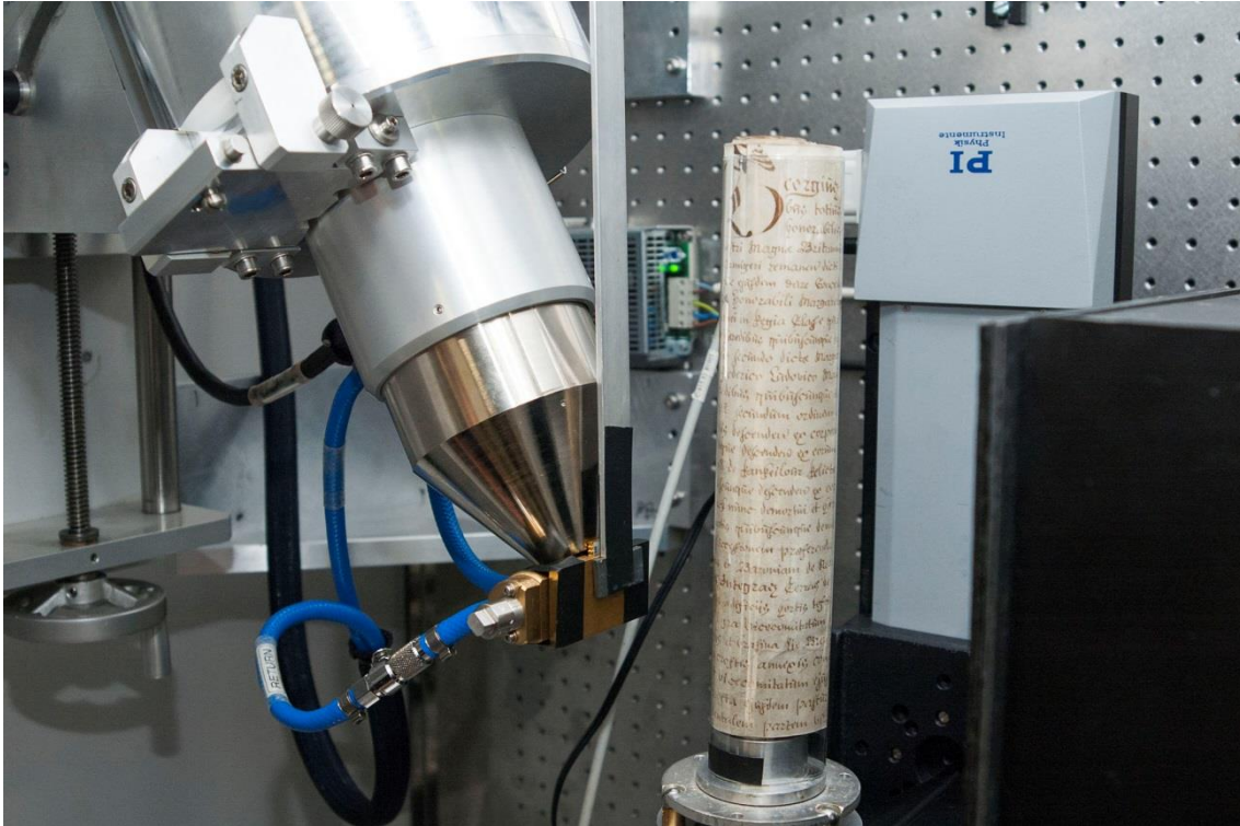
El sistema que permite leer pergaminos sin desenrollarlos. (Foto: Cortesía del EPSRC)
